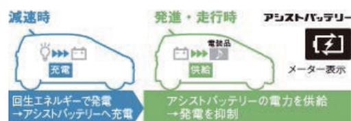
減速時の発電によってバッテリーを集中充電することにより、アイドリング・加速・クルーズなどの走行条件下での発電を抑制する技術です。エンジン負荷を軽減することにより、燃費向上を図っています。
