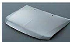
軽量化により燃費向上を図っています。安全性の向上にむけた、ボディサイズアップによる重量の増加を、アルミニウムや軽くて丈夫な高張力鋼板の採用や構造の合理化によって抑え、低燃費と安全性を両立させています。
