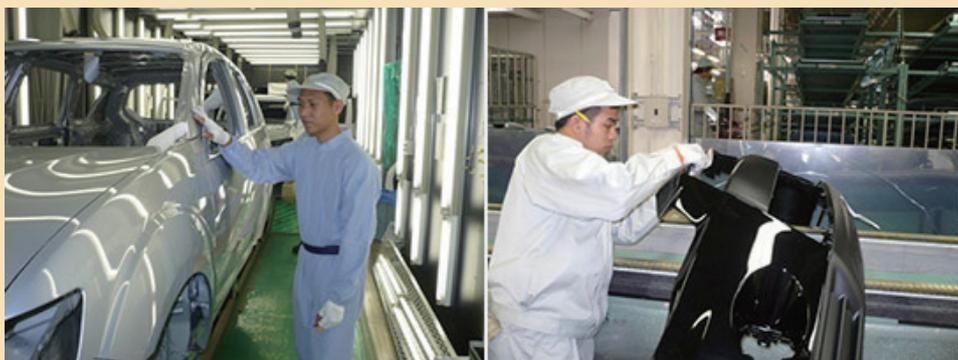
組立中の車両の塗装面に異物等がないか厳しい目で点検している様子
