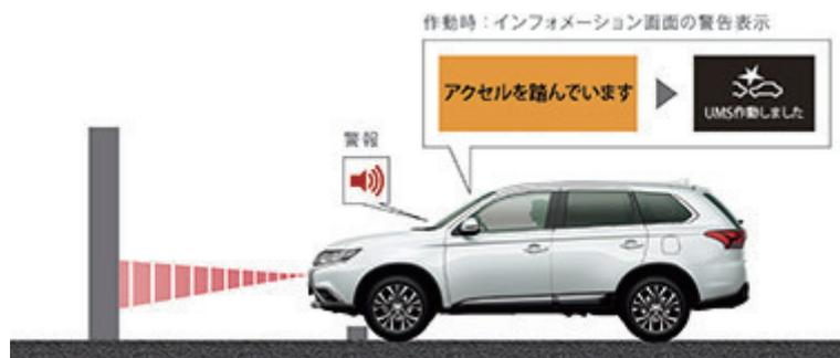
誤発進抑制機能（前進および後退時）の作動イメージ
