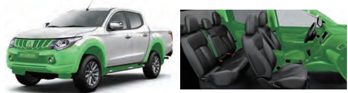
2014年発売の新型「トライトン」における、リサイクル容易な「熱可塑性樹脂」の主な採用箇所（グリーン部）
