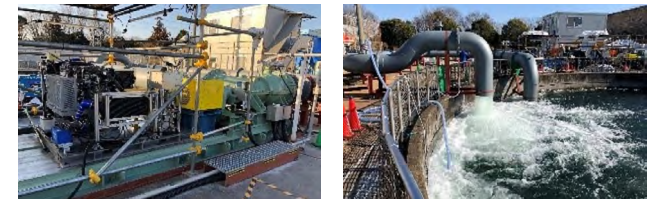
『デリカD:5』用エンジンを動力源として排水ポンプを駆動 実証試験時の排水の様子
