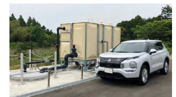
プラグインハイブリッド車からの給電試験の様子
