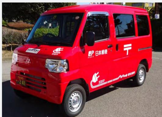
三菱自動車は、日本郵便株式会社（以下、日本郵便）に、郵便物や荷物の配送用車両として軽商用電気自動車『ミニキャブ・ミーブ』を2019年度から順次納入しています。2020年度末までに1,500台を納入し、比較的配送距離が短い大都市圏を中心に配備されています。走行中にCO<sub>2</sub>などの排出ガスを全く排出しないゼロエミッション車の活用により、温室効果ガス排出量の削減を目指す日本郵便の環境マネジメントの推進に貢献しています。
