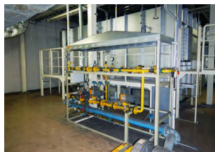
VOC 排出抑制のための電着乾燥炉用脱臭装置(岡崎製作所)
