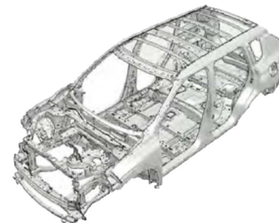
『アウトランダー』（PHEVモデル）に採用したRISEボディ
