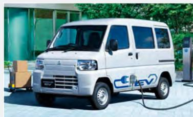
2023年12月に日本で発売した新型『ミニキャブEV』は、軽商用電気自動車として12年間で、約13千台（2023年10月末時点）の販売実績を持つ『ミニキャブ・ミーブ』をベースに同車の開発・メンテナンスで得られたノウハウを最大限に生かして大幅改良し、航続距離を先代モデル比で約35%増となる180km（WLTCモード）に延長するとともに、安全装備・機能装備の拡充を図りました。
