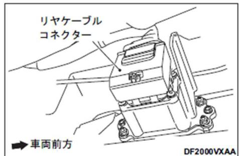
2. 手順1の作業が困難な場合や、エンジルーム及びモータールームを止むを得ず整備作業する必要がある場合は、FPDU及びリヤモーター側の高電圧ケーブルを切離す。
