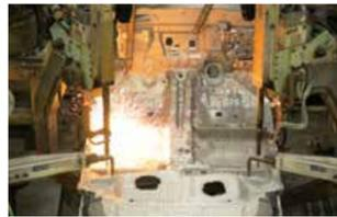
ロボットが強い電流を流して金属と金属をくっつけてクルマの形にします。
