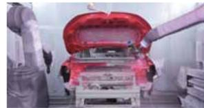
サビ止めのための「下塗り」、塗装をはがれにくくするための「中塗り」、色の付いた塗料で仕上げる「上塗り」、ツヤを出してきれいにする「クリア塗装」の4段階に分けて色を塗ります。
