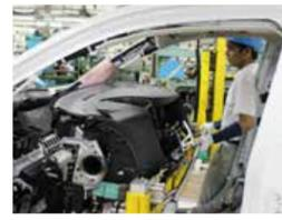
ラインを一定の速さで進むクルマに流れ作業で部品を組み付けます。
