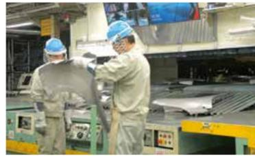
車体の材料になる薄い鉄板(鋼板)を強力なカッターで切断します。切断した鋼板は強力なプレス装置で押しあわせて、床板やドアなどの部品をつくります。
