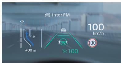
運転操作の楽しさを最大化させる情報提供・内容把握時間の少なさを実現させる表示板機能 / 配置、GUIデザイン(イメージ)
