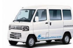
乗員2・4名／総電力量10.5kWh・16.0kWh
