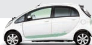
1990年代はじめまで、電気自動車の基幹部品であるバッテリーは鉛電池が主流で、電池自体の重さが車両全体の約半分の重さを占めていたことが実用化のボトルネックとなっていました。当社はエネルギー密度や出力密度の面で優れており、小型軽量化が可能なリチウムイオン電池にいち早く注目。『i-MiEV』ではリチウムイオン電池を採用したことで電池重量が車両重量の20%以下となり、実用域に達しました。
