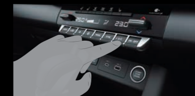
グローブをしたままでも直感的に操作できるエアコンスイッチ
