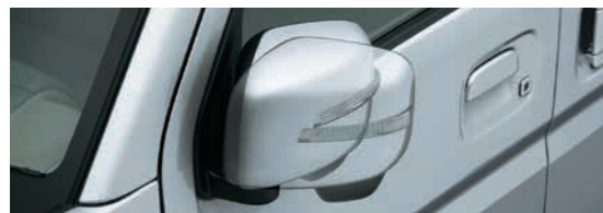
電動格納式リモコンドアミラー(LEDターンランプ・リモート格納付) ※写真はGスペシャルです。
