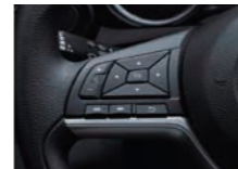
ステアリングスイッチ (マルチインフォメーションディスプレイ+オーディオ+TEL)
